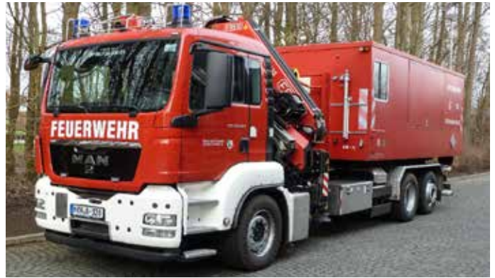
Ein Wechsellader mit Kran der 26-Tonnen-Klasse (MAN TGS 26.400) und Abrollbehälter „Strahlenschutz“ (WLF 26-KR mit AB „Strahlenschutz“) zählt zu den größten Ausbildungsfahrzeugen des Instituts.
