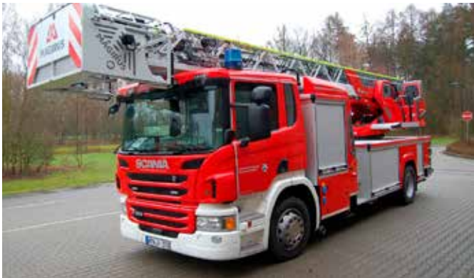
„Florian IdF 01-DLK 23-01“ ist eine Magirus-Leiter (DLK 23/12) auf Scania-P320-Fahrgestell.
